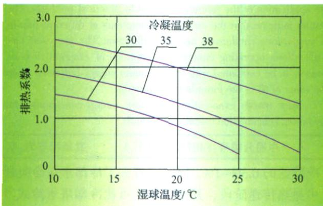
图 2 某品牌蒸发式冷凝器排热系数(R717)
