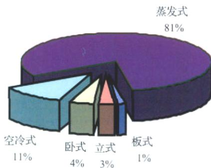
图 1 美国、加拿大 62 个系统冷凝器型式统计
